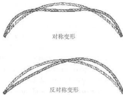
图 2 桁架拱的屈曲变形
