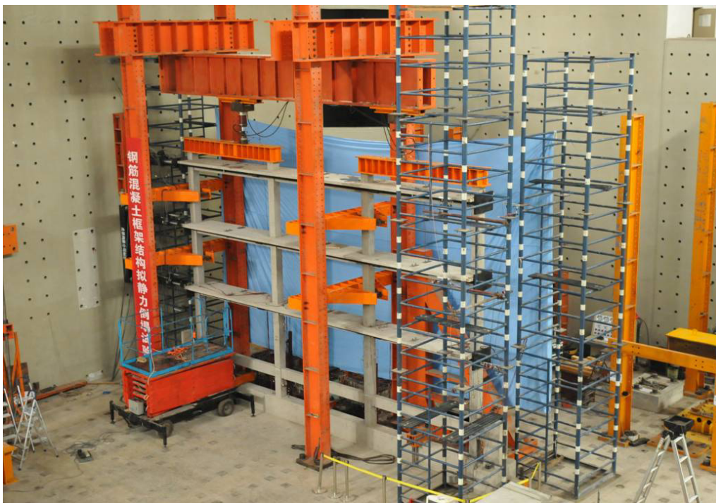
图 1 钢筋混凝土整体框架试验布置
