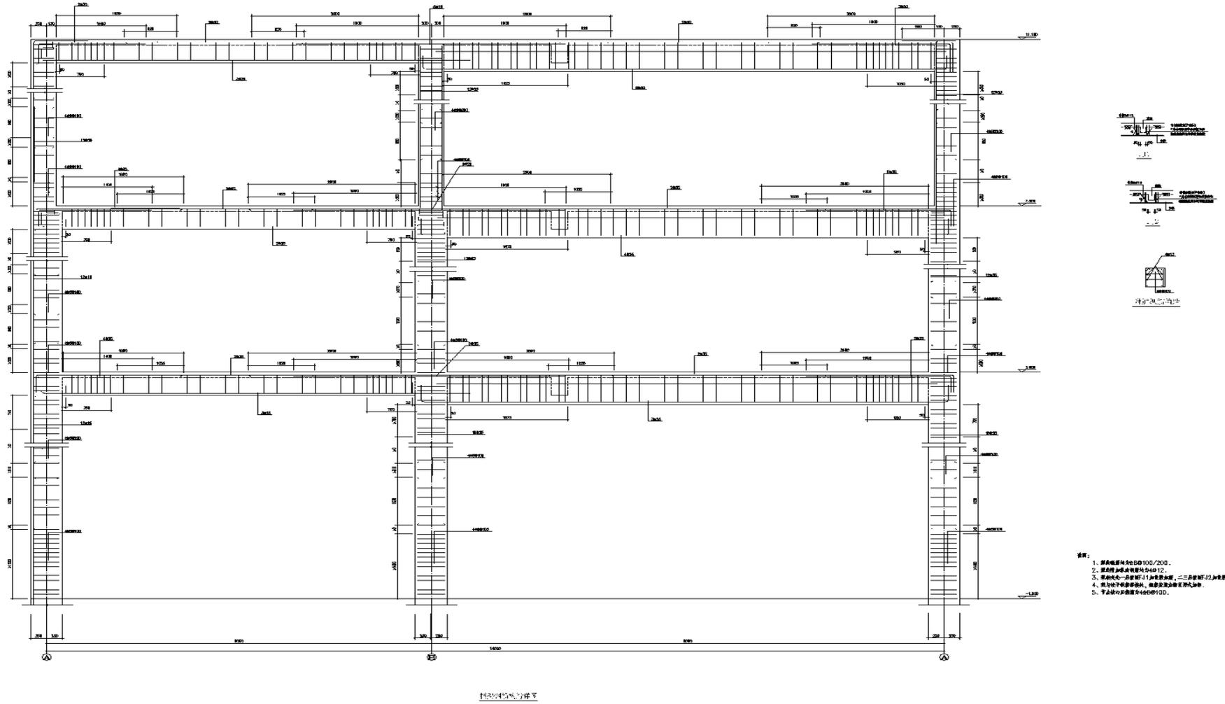
图 6.13h 框架钢筋构造详图
