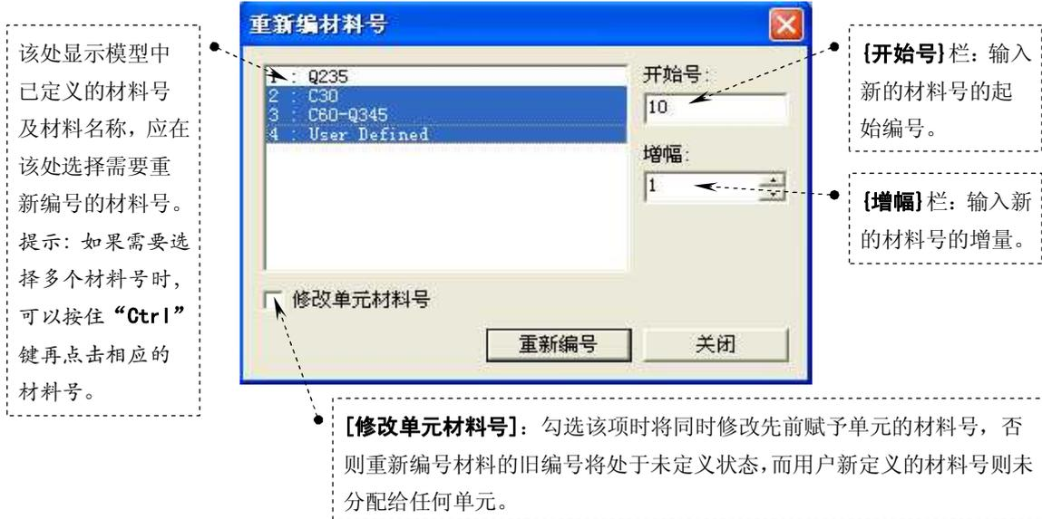
图 2.5-5 重新编材料号对话框
