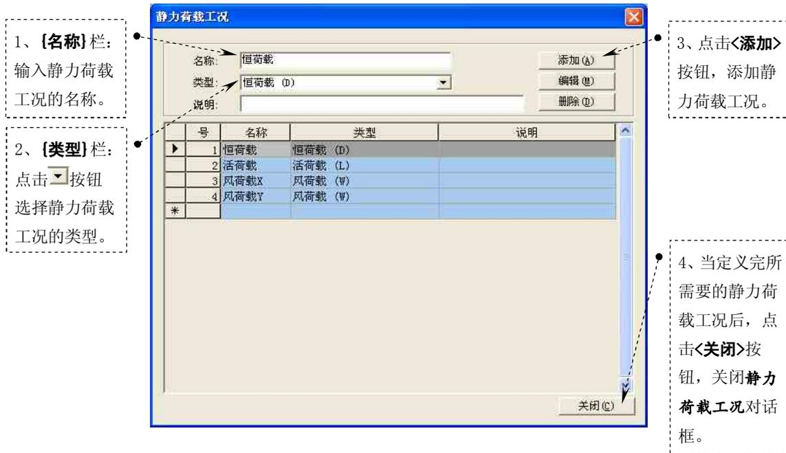
图 1.1-20 静力荷载工况对话框
