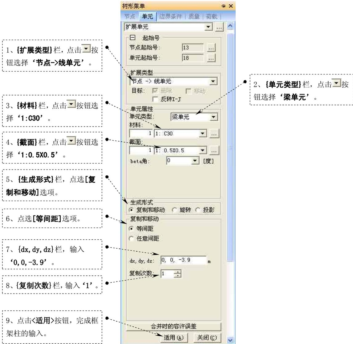
图 1.1-13 框架柱的输入
